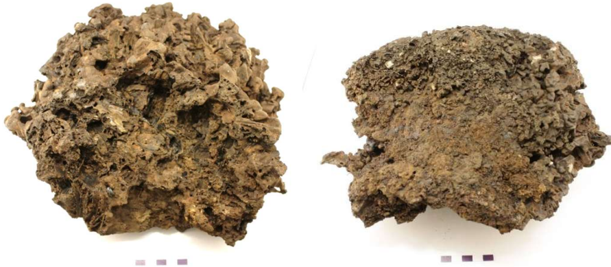
Figur 17. Bottenslagg prov 6 från ugnen. Ovansida och botten (kurvaturen i övre kanten visar kontakt mot vägg(grop)).
