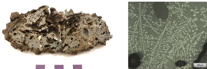
Figur 25. Bottenlagg prov 13b från slaggvarp 2, delat tvärsnitt med porös slagg, rester av kolstycken (centralt i överkanten) och fläckvis med metalliskt järn. Tunnslipsanalys och kemisk analys längs högra kanten. Infällt foto från mikroskopet; se bilaga 3 för detaljer.
