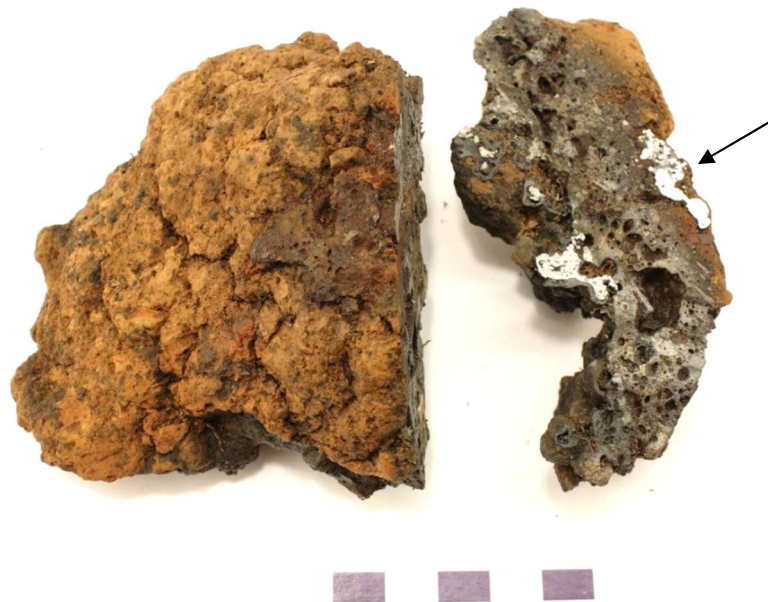
Figur 2. Utsida av blästersköld med genomskärning som visar värmegradienten från lägre bränd, oxiderad utsida till deformerad insida med slagg och järninklusion (analyserad vid pilen) (P8, ugn, L1945:8276).
