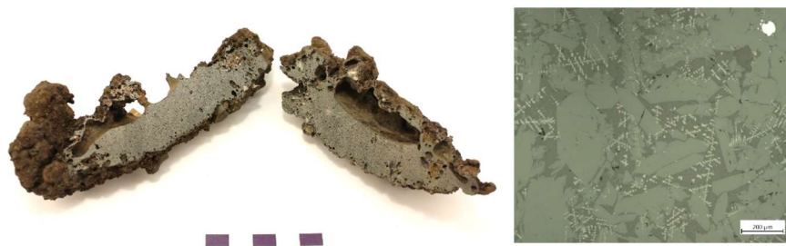
Figur 16. Bottenslagg prov 5 från ugnen, delat tvärsnitt. Den centrala täta slaggen är analyserad (tunnslip och kemi). Infällt foto från mikroskopet; se bilaga 3 för detaljer.
