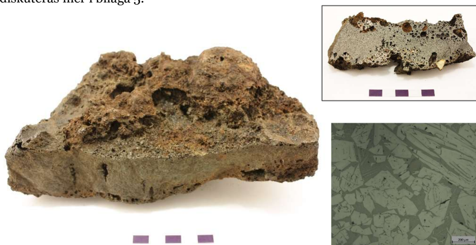
Figur 21. Bottenslagg prov 10 från slaggvarp 1 sedd snett ovanifrån som visar den täta homogena slaggen, vilket ses i den lilla infällda bilden på delat tvärsnitt, med en liten sten insmält i botten. Infällt foto från mikroskopet; se bilaga 3 för detaljer.
