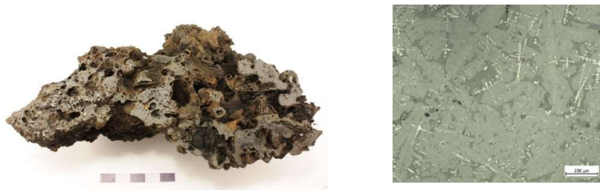
Figur 18. Bottenslagg prov 6 från ugnen, delat tvärsnitt. Slaggen i högra kanten är analyserad (tunnslip och kemi). Till vänster ses också lite metalliskt järn som små ljusa fläckar. Infällt foto från mikroskopet; se bilaga 3 för detaljer.
