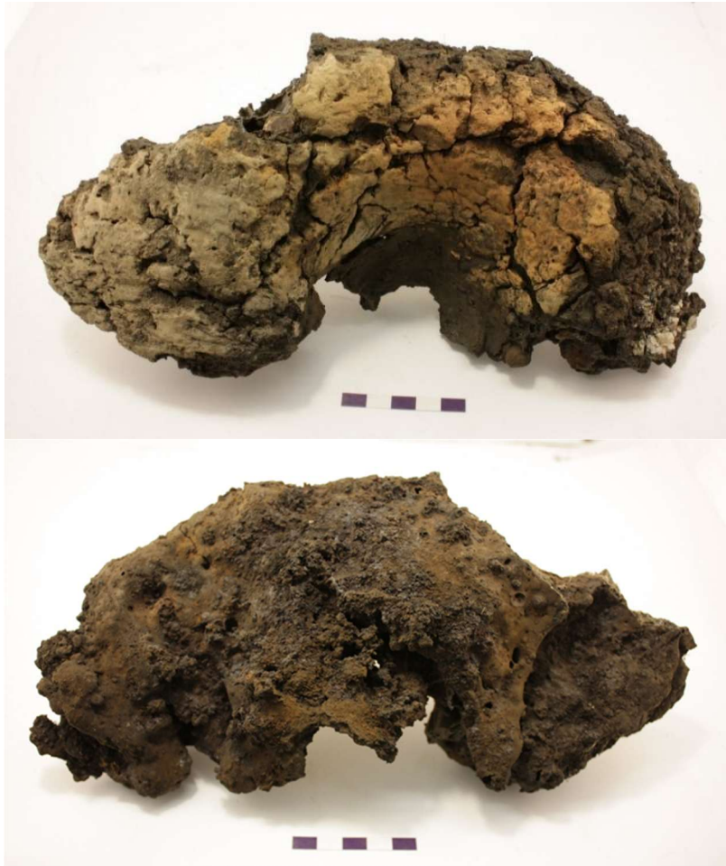
Figur 5. Utsida (ovan) och insida (nedan) av fragment av blästersköld med trattformat formaavtryck (ovan) och kraftig slaggbildning på insidan (nedan) (P11, slagghvarp 1, L1945:8276).
