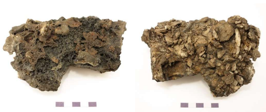
Figur 22. Bottenslagg prov 13a från slaggvarp 2. Ovansida och botten, med slagg fastsmält mot lerfragment.
