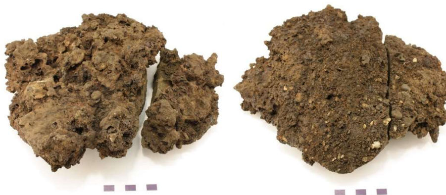
Figur 15. Bottenslagg prov 5 från ugnen. Ovansida och botten.
