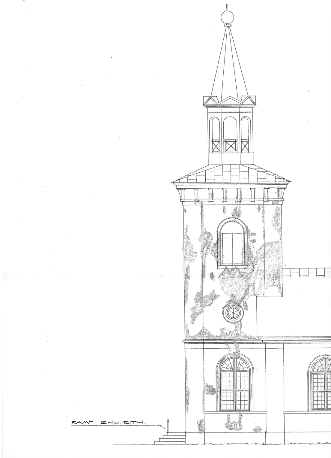
Putslagningar på den södra fasaden.
