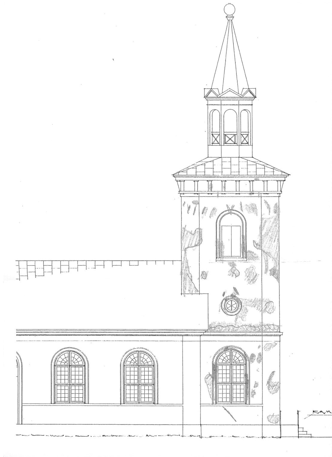
Putslagningar på den norra fasaden.
