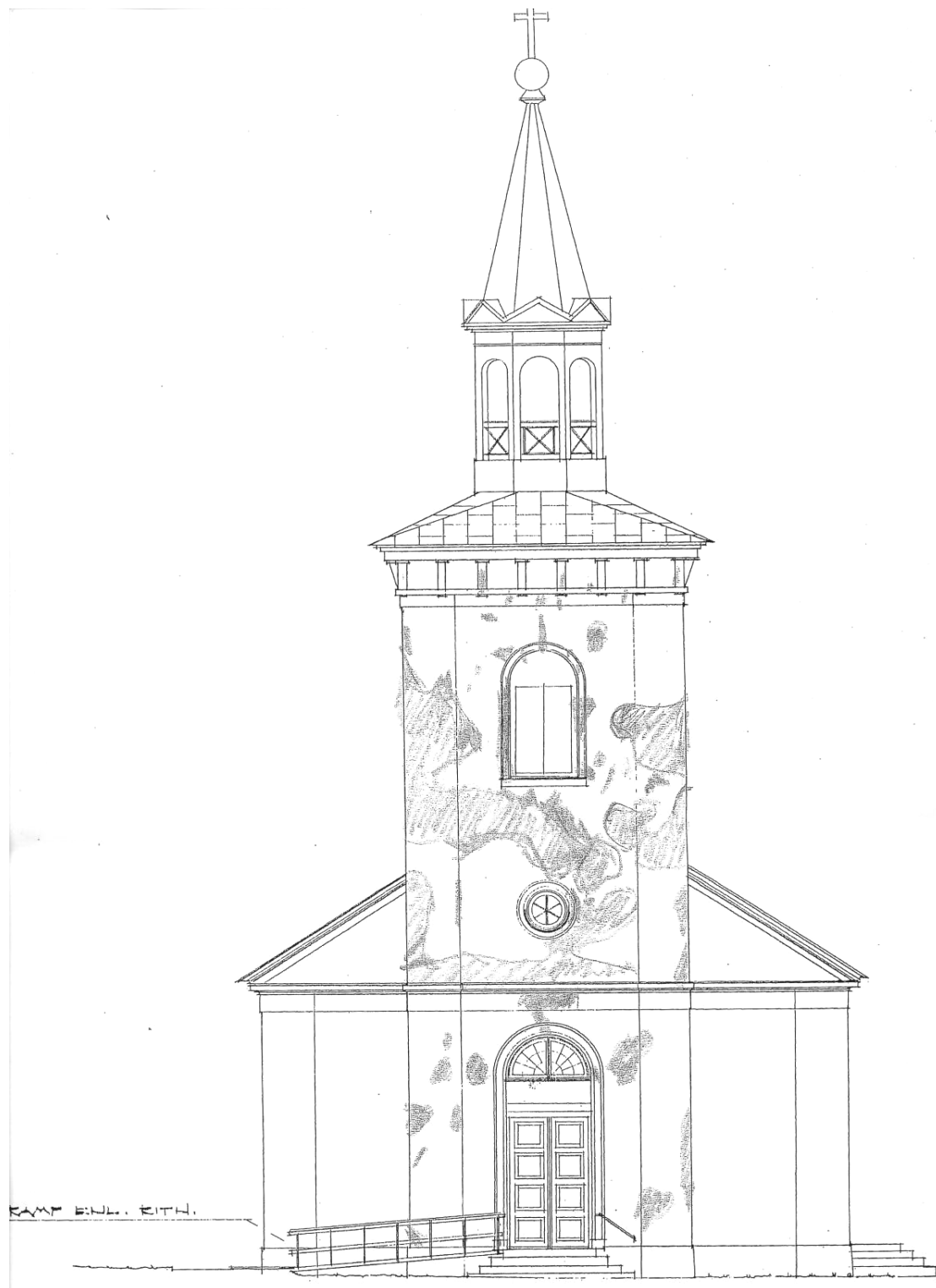
Putslagningar på den västra fasaden.
