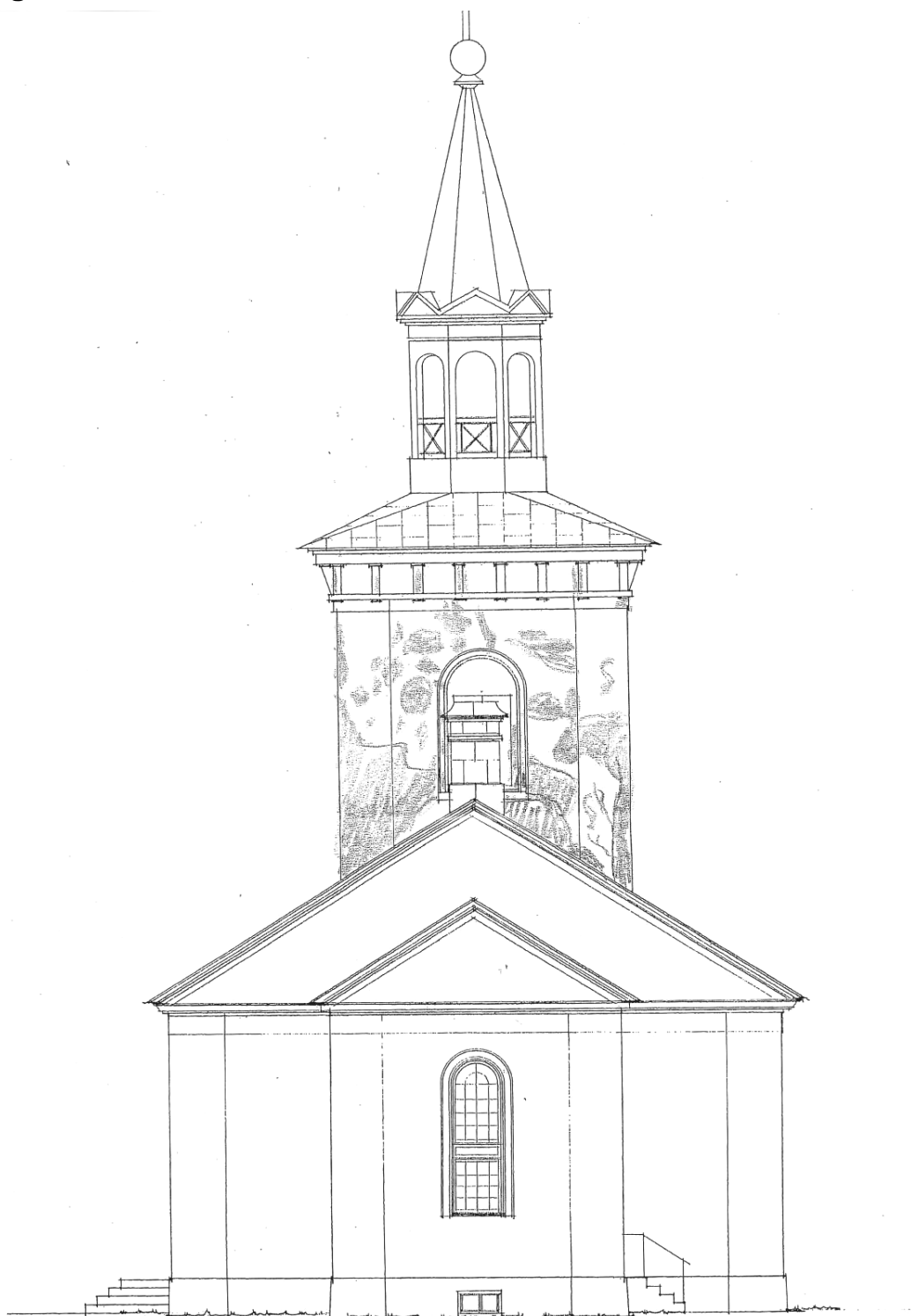
Putslagningar på den östra fasaden.
