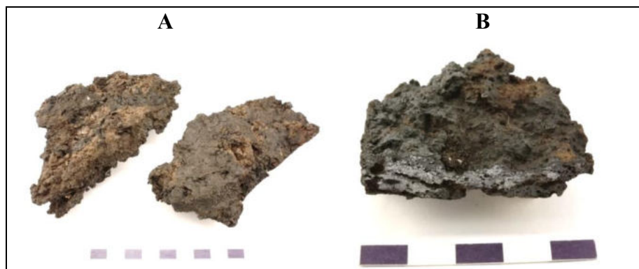
Figur 36. P31 från slagghvarp A546 (L2022:10033). A: Två av de slagger som är tunna, trögflutna, något spröda och vanligen blå-grå på ytan sedda från två sidor. B: i delat tvärsnitt ses svampigt, metalliskt järn med en del hålrum och omgivande slag.
