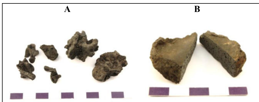
Figur 31. P45 från nedre fyllningen i ugn A180, L1945:9225. A: blandat material med små stearinformade slagger ingår, liksom sådana med övergång mellan stearinformade slaggsträngar och mer trögflutna slagger. B: Tvärsnitt av slaggen som har analyserats. Den är homogen i sin uppbyggnad.
