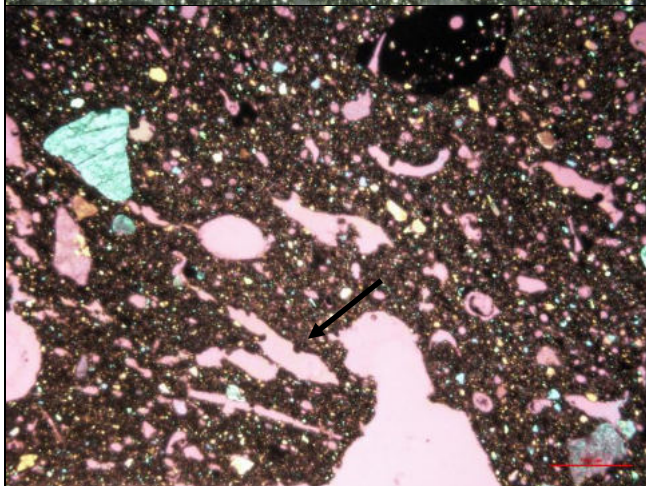
Mikroskopfoto av TS 1 som visar hålrum efter växtmagring (pil) Krysspolariserad med lampda-kompensator.
