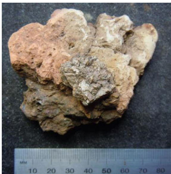
Figur 10. Utsidan av ett fodringsfragment från P39 (A180, L1945:9225) med fastsintrat stenschaktsfragment. Den varierande oxiderande-reducerande bränningsatmosfären för leran intill stenschaktet ses av den skiftande färgen (röd till grå).
