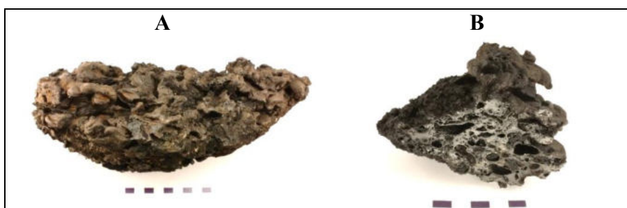
Figur 23. Bottenslagg, P7 från slaggvarp (L2022:10033). A: sedd i profil med stearinformade slagsträngar på ytan. B: delat tvärsnitt med porig slag med inkapslade kolstycken och ansamlingar av metalliskt järn.
