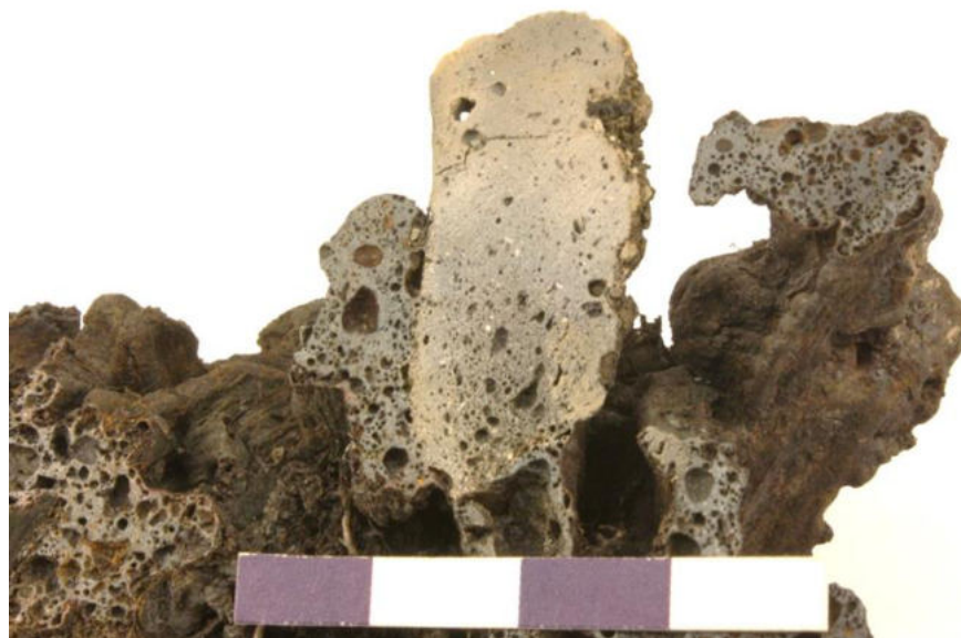
Figur 14. Genomskuret fodringsfragment med en formad insida till vänster, inbäddat i slagg och fläckvis sintrat (fina blåsor) från värmepåverkan från slaggen (P21, A489, L2022:10033).
