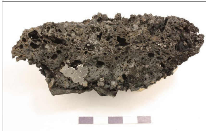
Figur 25. Bottenslagg, P58 från slaggvarp A245 (L1945:9225). Delat tvärsnitt med en homogen uppbyggd, porig, trögfluten slagg. Metalliskt järn förekommer rikligt och i en större ansamling i nedre vänstra delen.
