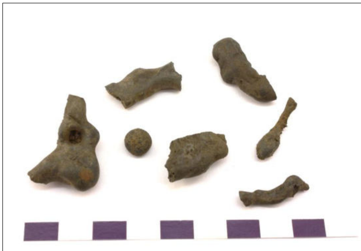
Figur 29. P65 från slaggvarp A405 vid fällstenen på blästplatsen L1945:9225. Exempel på små slaggdroppar och stearinformade tunna slaggsträngar.
