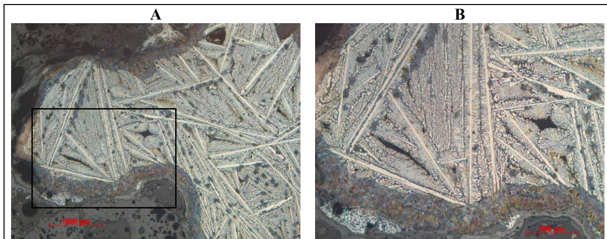
Figur 6:5. Foton från mikroskopet på analyserat järn, P63, från blästplatsen L1945:9225. A: översiktsbild på det polerade och etsade provet med en avtagande kolhalt mot ytterkanten. I detta prov är kolhalten ännu högre i kärnan än i föregående figurer, med gjutjärn (vita lameller av cementit). En blåbrun zon med perlit närmare kanten har motsvarande kolhalt som P53 och p58, samt en yttre ljus zon med låg kolhalt (ferrit och lite perlit). B: detalj på kanten från rutan i A.
