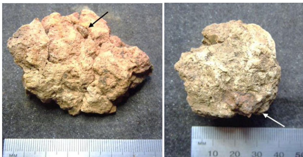
Figur 7. Till vänster, fodringsfragment av fin, siltig lera med större bergartsfragment (pil) och till höger annat fragment med slagfragment (pil) från P39 respektive P41; A180, L1945:9225.
