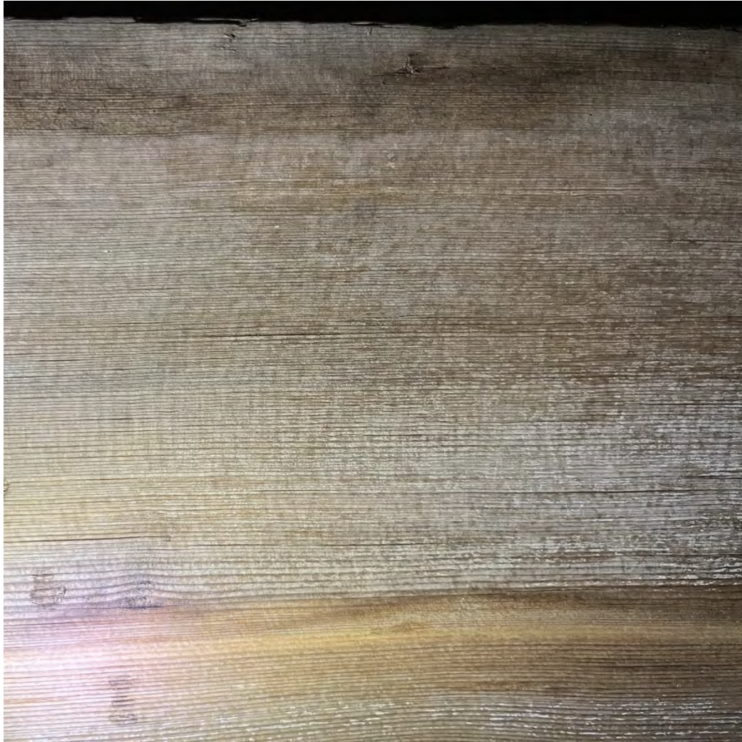
Fig. 115. Närbild av vibrationsspår efter en skave på insidan av plankan S15 T5–T7. Ytan som avbildas mäter ca 15×15 cm.
