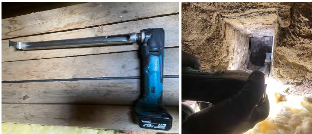
Fig. 40 a–b. Multimaskin med förlängning tillverkad speciellt för provtagningen i Frösö kyrka av Håkan Berggren, Jamtli. Foton: OH.
