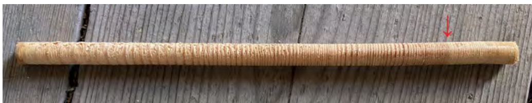
Fig. 4. Mörkare kärnved och ljusare splintved i ett prov utborrat ur en furubjälke. Den röda pilen markerar gränsen däremellan. Längst t.v. ses en bit av trädets märke. Provet är taget i klocktornet i Brunflo. Foto: OH.
