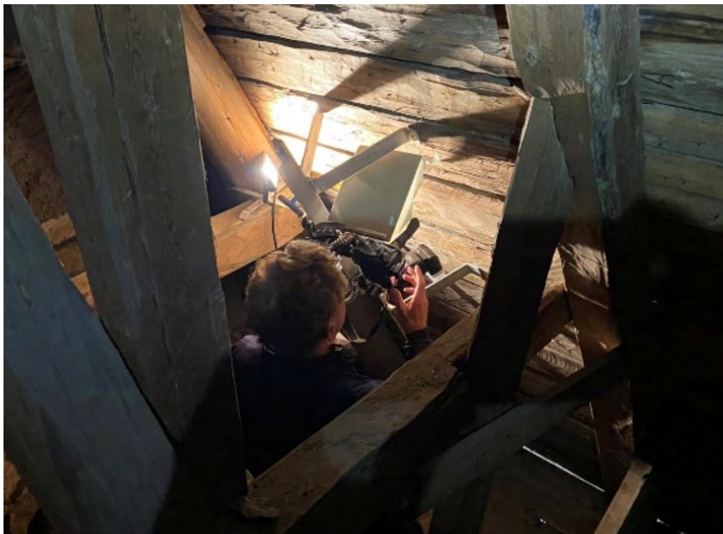
Fig. 131. Fotografering för dendrokronologisk analys av takbrädor med hjälp av en rigg konstruerad speciellt för ändamålet av Björn Olofsson och Mikael Hopstadius, Jamtli. Här under 2022 års provtagning i Marby gamla kyrka (Björn vid kameran). Foto: OH.
