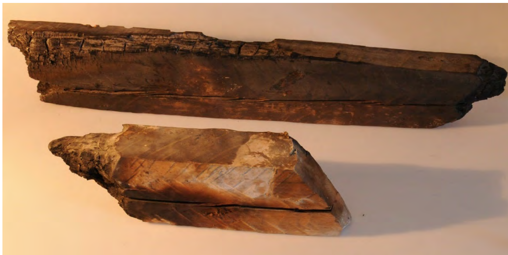
Fig. 36. Sparrstumparna som utdragits ur hål nr 3 (överst) respektive nr 1 (nederst), räknat från öster, i norra muren i Frösö kyrkas långhus. Dessa förvaras för närvarande på Jamtli. Foto: BO.
