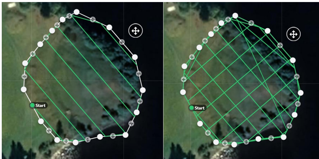
Figur 17. Till vänster är en ruttplanering utan 3D, till höger är en ruttplanering med enhanced 3D.
