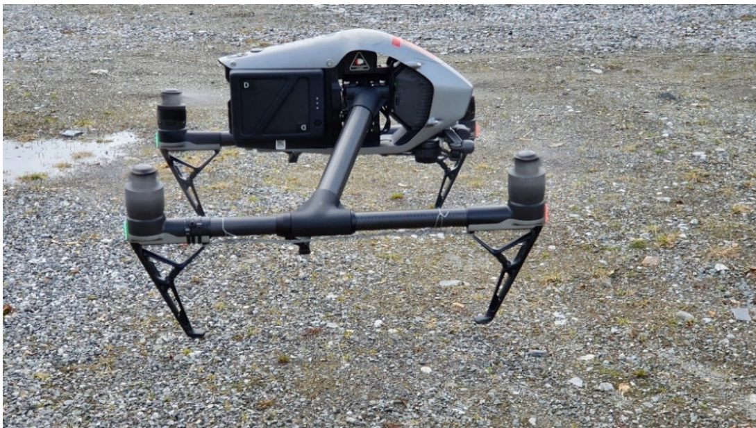
Figur 16. Testflygning med provisorisk lagning bestående av buntband och ståltråd.
