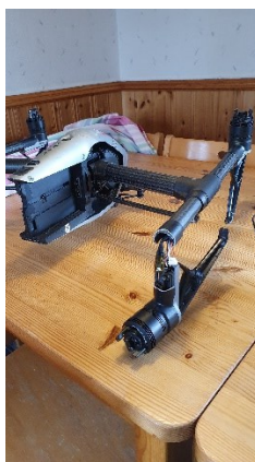
Figur 15. Skador på drönaren efter haveri.
