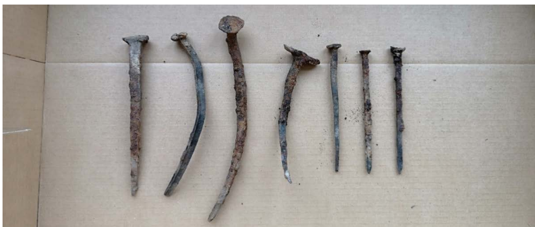
Bild 5. Ett fåtal av de spikar som framkom i lager L10-20. Till vänster är exempel på handsmidda spikar och till höger mer moderna maskintillverkade. Samtliga fynd förvaras på Jamtli.
