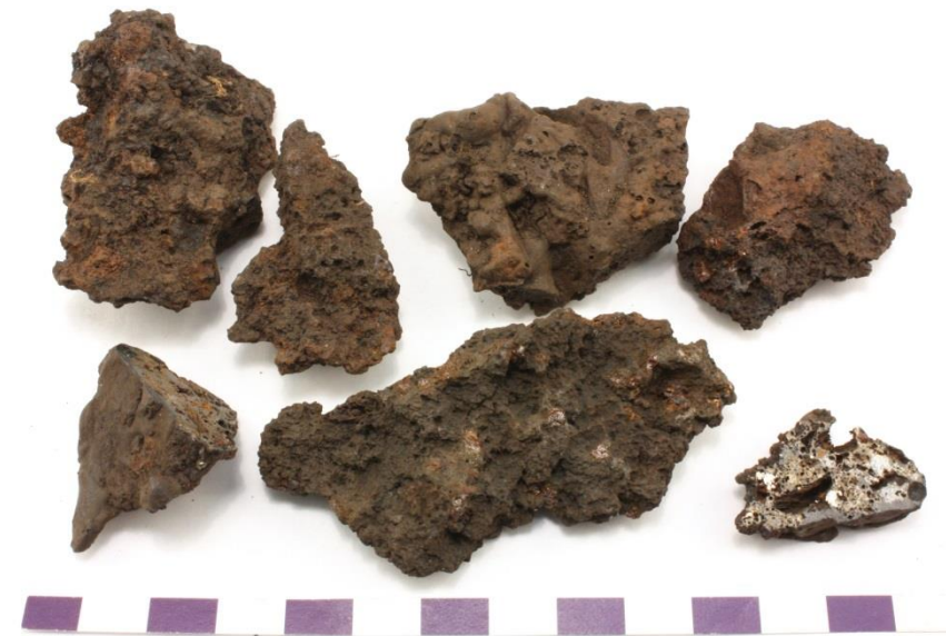
Figur 7. Prov RSF2 (fällstenslagg) där alla bitar analyserades kemiskt (181,6 g) och stycket nere till höger preparerades till tunnslip (taget från sågad bit nere till vänster).
