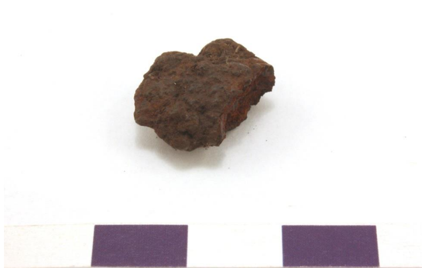
Figur 9. Prov RM3, som var den största bortsållade biten från malmen, preparerades till tunnslip. Ytterligare tre mindre bitar (RMP) från sållet preparerades till ett polerprov.
