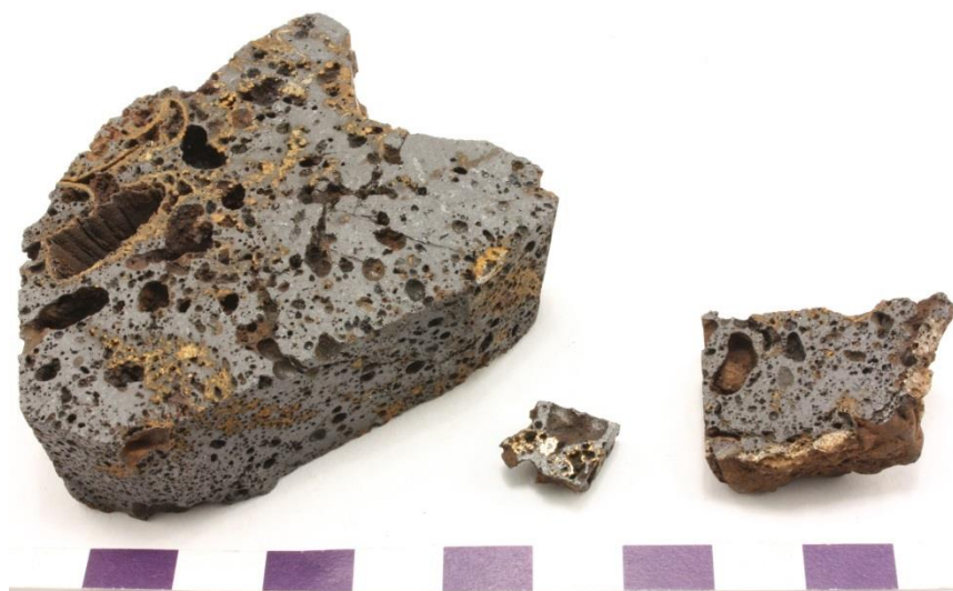
Figur 5. Prov RS5 (reduktionslagg) efter sågning där den vänstra biten analyserades kemiskt (181,6 g), den mellersta polerades med avseende på järninnehållet (polerprov RS5J) och den högra preparerades till tunnslip. OBS att tunnslipet är taget så att både dess undersida och kant mot ugnen ingår.
