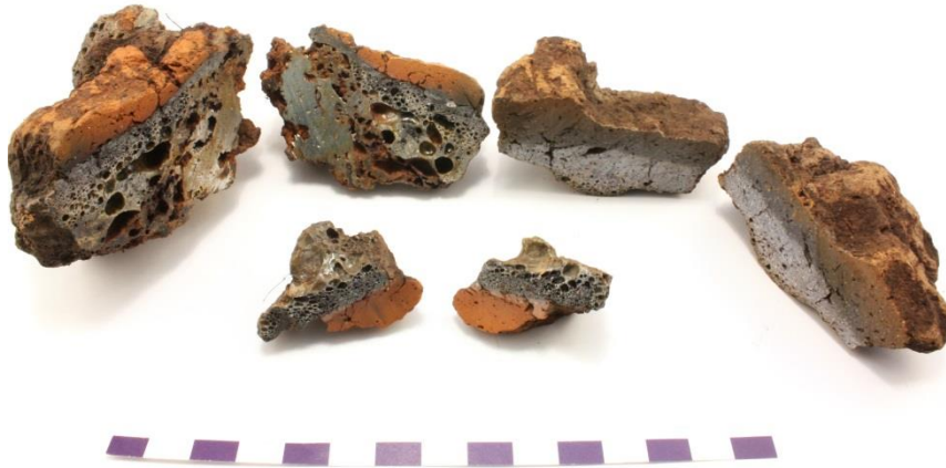
Figur 10. Tre bitar av ugnsvägg delades. Biten till vänster innehåller stor mängd järn, medan biten till höger förefaller lägre bränd.
