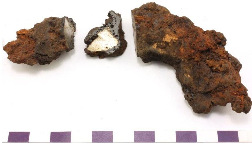
Figur 8. Prov RSJ9 (slag sannolikt från fornan) efter sågning där mittbiten polerades huvudsakligen med avseende på analys av järnet.
