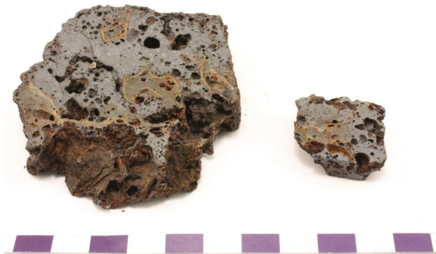
Figur 4. Prov RS4 (reduktionslagg) där den vänstra biten analyserades kemiskt (131,1 g) och den högra preparerades till tunnslip.
