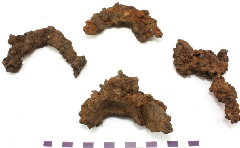
Figur c. Reduktionsslagg från forman. Notera avtrycket i den främre biten (se bild nedan). Den övre biten sågades och preparerades till polerprov med avseende på järnet (prov RSJ9).
