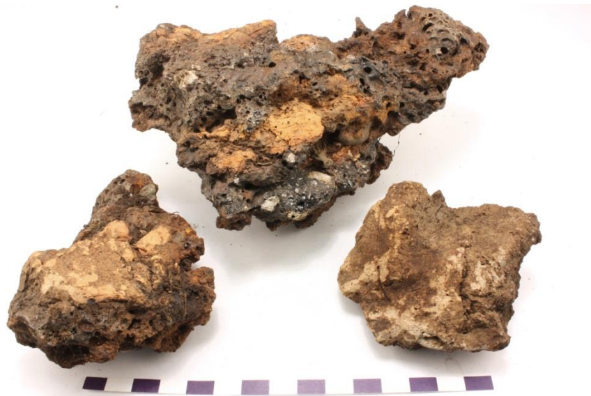
Figur e. Exempel på några bitar av ugnsvägg/teknisk keramik. Det högra stycket förefaller mindre bränt.
