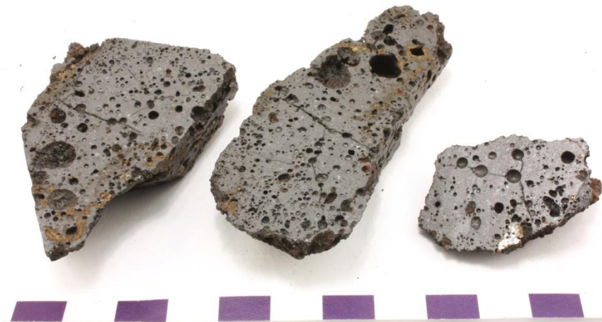
Figur 3. Prov RS3 (reduktionsslagg) efter sågning där de två vänstra bitarna analyserades kemiskt (128,8 g) och den högra, med metalliskt järn i nederkanten, preparerades till tunnslip.
