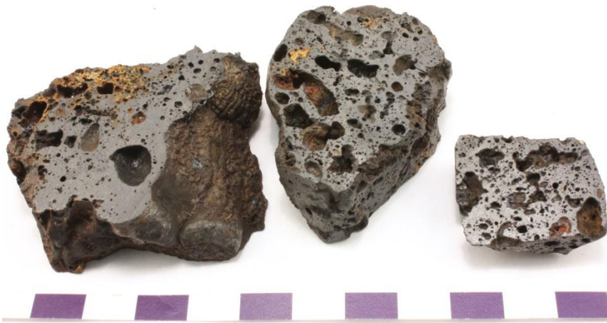
Figur 2. Prov RS2 (reduktionsslagg) efter sågning där de två vänstra bitarna analyserades kemiskt (152,6 g) och den högra preparerades till tunnslip.
