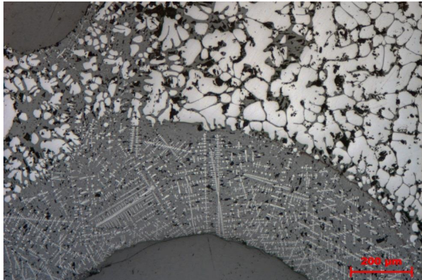
Figur 16. Ljusgrå wüstit dominerar detta slagprov (RS3), men i nedre delen av denna bild ses ett område där grå olivin istället dominerar och där wüstiten är finkornig och växer dendritiskt.
