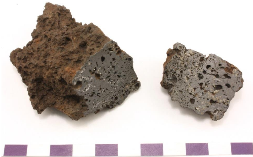
Figur 6. Prov RSF1 (fällstenslagg) efter sågning där den vänstra biten analyserades kemiskt (120,2 g) och den högra preparerades till tunnslip.
