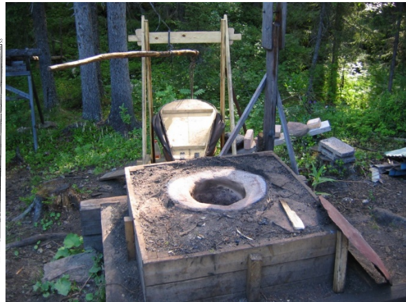
Bilden till vänster föreställer konstruktionen av en Evenstadsugn (Espelund 2008, s 65). Den högra bilden visar rekonstruktionen av en Evenstadsugn som finns vid Hammarede. (Foto: Anna Engman)
