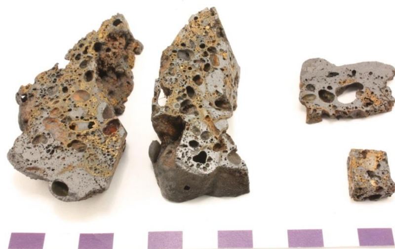
Figur 1. Prov RS1 (reduktionsslagg) efter sågning där de två vänstra bitarna analyserades kemiskt (107,6 g), den övre högra preparerades till tunnslip och den nedre högra polerades med avseende på järninnehållet (polerprov RS1J).
