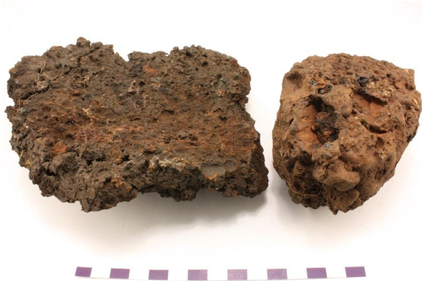
Figur b. Trögfluten reduktionsslagg med avtryck av botten/sidor av ugnen. Den högra biten analyserades kemiskt och i mikroskop (prov RS5).
