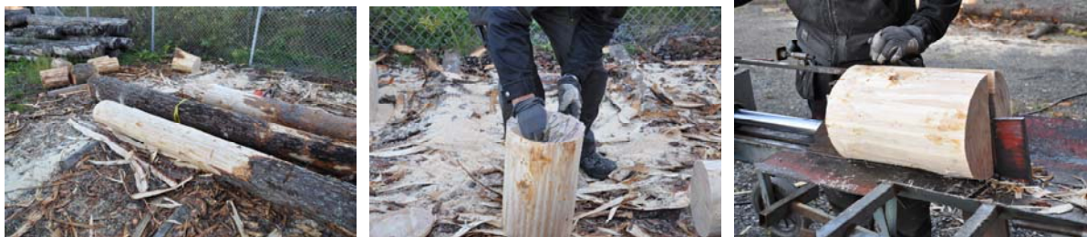
Barkade stockar. Tallar som omsorgsfullt valts ut redan i skogen för att passa till takspånstillverkning. Kubbarna märks så man ska veta vad som är upp på trädet vid klyvning av spånen.
