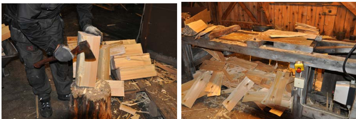
Klyvning och borttagning av de första årsringarna innan spånen klyvs i denna spånklyv.
