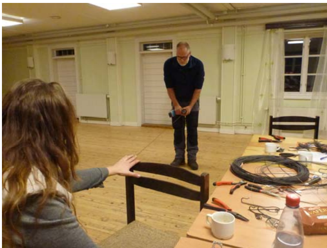
Två trådar tvinnas med en bormaskin. Ove Hedenström håller i bormaskinen.
