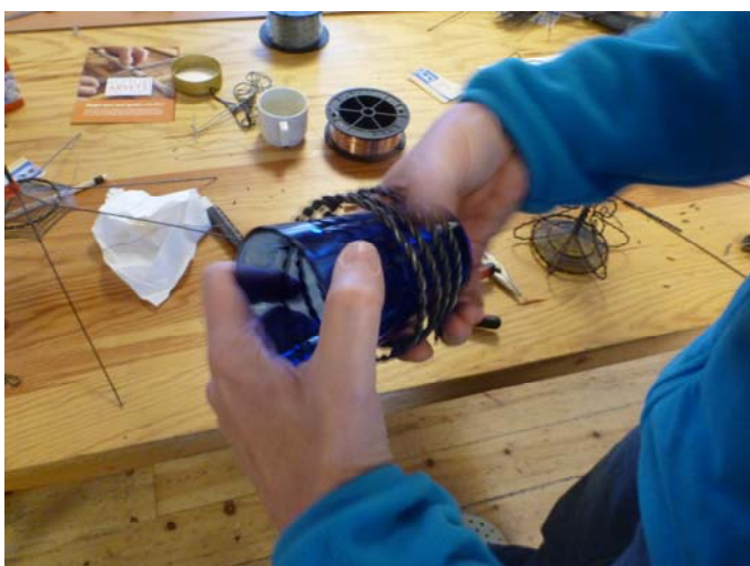
Ett glas kan användas för att få den tvinnade tråden jämn och rund.
