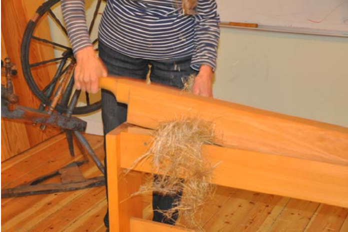
Bråkning, det första momentet för att skilja veden från fibern på linstråna.
