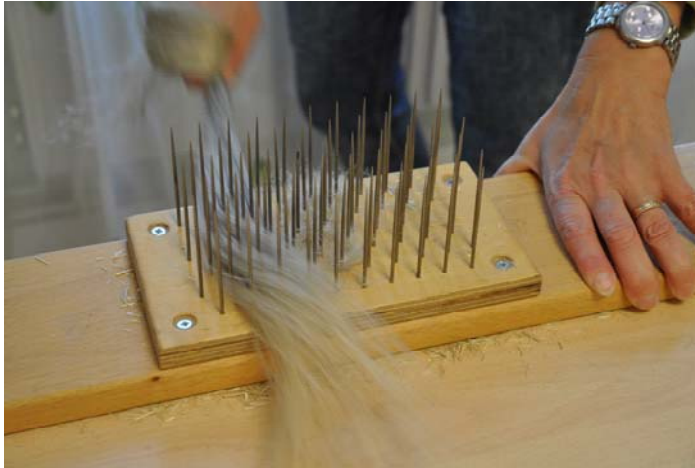
Linet grovhäcklas först genom att dras genom en kam där det är glest mellan piggarna. Det mesta av veden försvinner.
