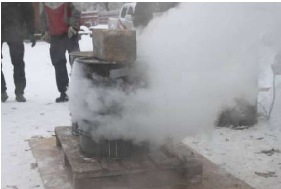
För att få en ultimata reaktion lades locket på fatet och någonting tungt ovanpå för att göra att stenarnas reaktion med vattnet och värmeutvecklingen blev så snabb och reaktiv som möjlig.
