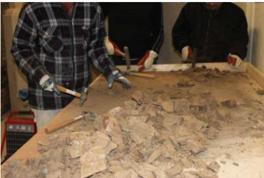
De brända stenarna slogs sönder i mindre bitar. Stenarna bör få en ungefärlig jämbördig storlek för att släckningen ska bli jämn.
