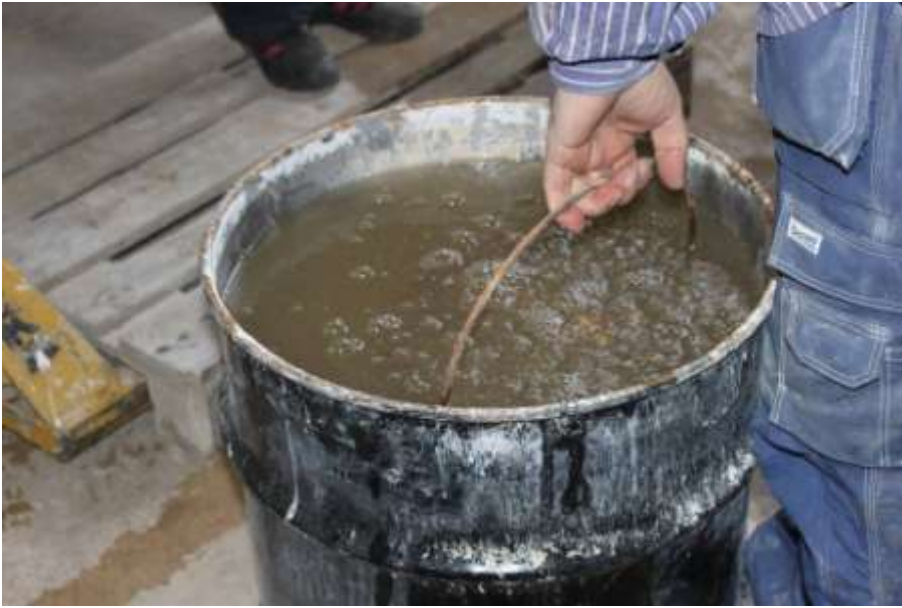
Den perforerade hinken fylld med stenar sänktes ner i ett fat med varmt vatten. Hinken hölls nere i ungefär 20 sekunder till dess att bubblandet minskade.
