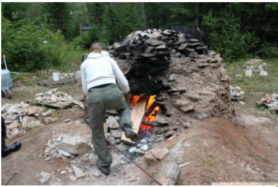
Kalkmilan som högskolan på Gotland brände inom ramen för undervisningen på byggnadsantikvarieprogrammet. Studenterna jobbade i skift med eldningen.
