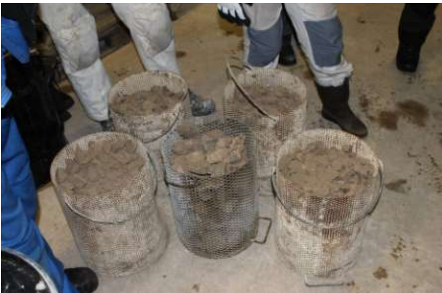
De nedknackade stenarna lades i perforerade korgar av stål.
