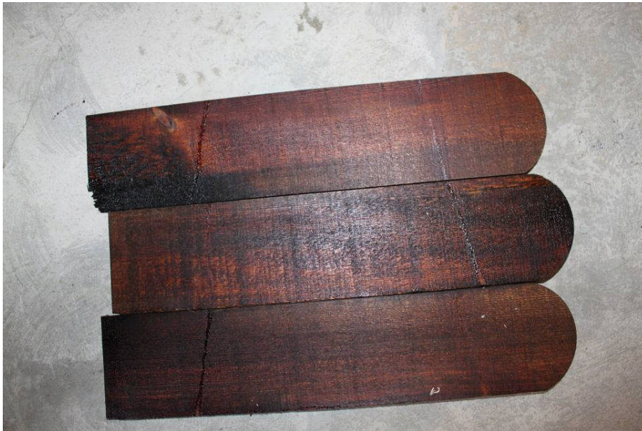
Spånen har blivit tjärade innan de levererats, de raka spåren efter bandsågen syns genom tjärningen
