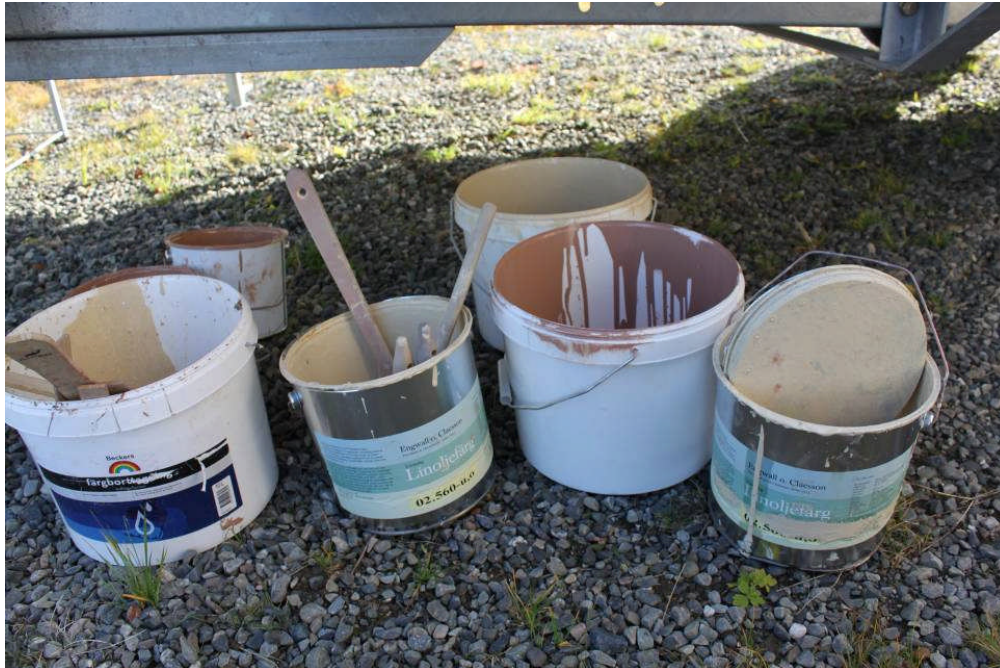
Detta är vad som har använts till fasaden: färgborttagning, Alcro-Beckers AB, gul linoljefärg med beteckning 05.260-U,O och en brunrosa kulör med beteckning 01.163-U,O. IMG_2074 Foto: Clara Nyström
