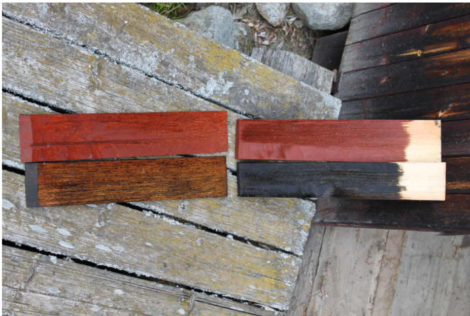
Bild 3. Uppstrykningsprover för dalbränd tjära av märket Claesson pigmenterad med rödfärg alternativt kimirök (digital bild nr 023).
