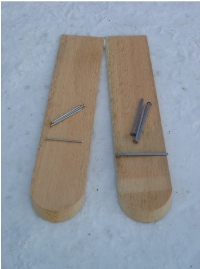
Nya spån, till vänster ligger rostfria spikar avsedda för dold spikning på högra ligger smidd spik för synlig spikning av spånet
