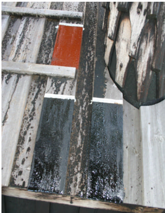
Bild 8: Uppstrykningsprover på klockbodens faltak pigmenterat med Falurött, kimrök samt opigmenterad.
