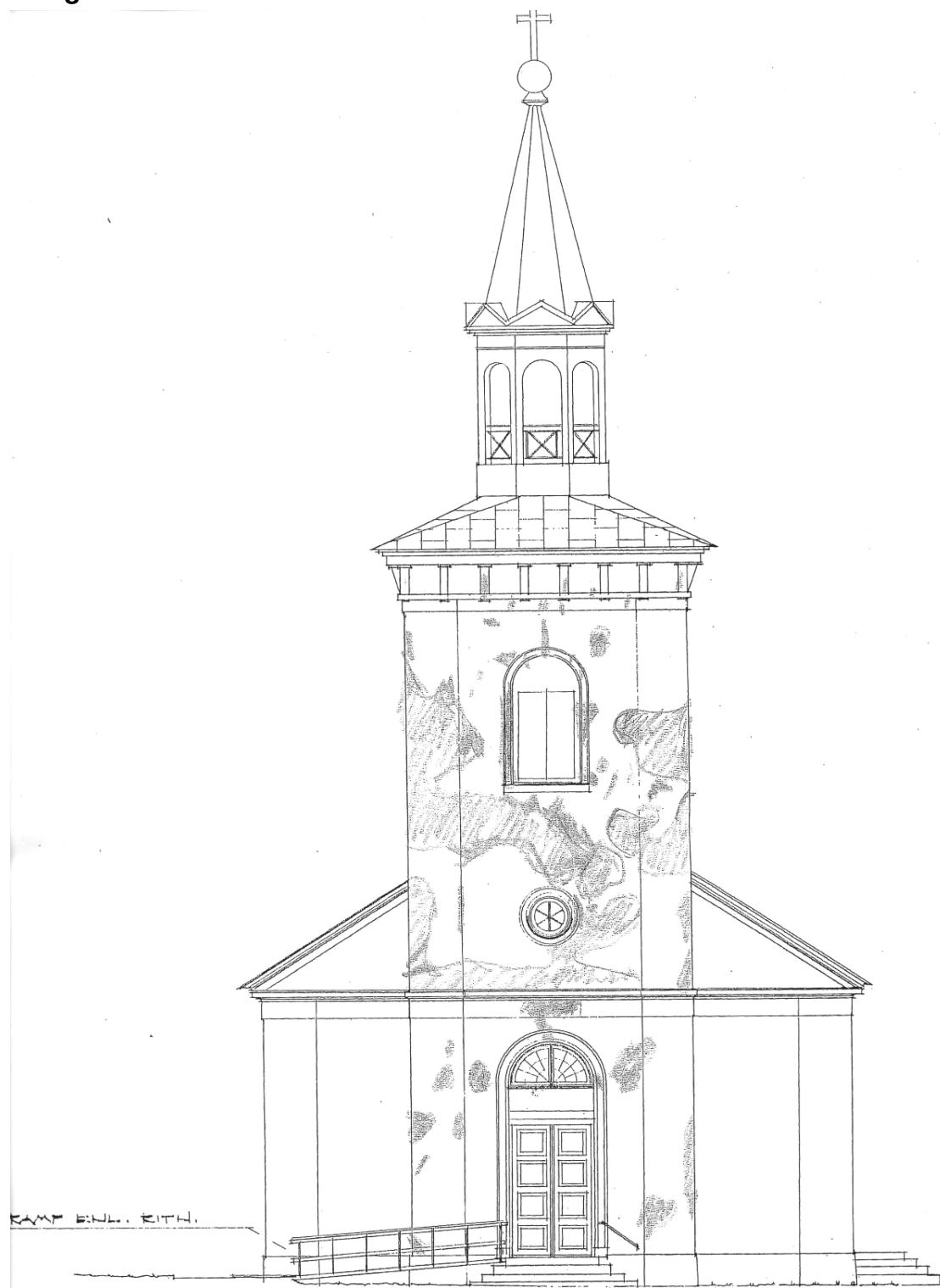
Putslagningar på den västra fasaden.
