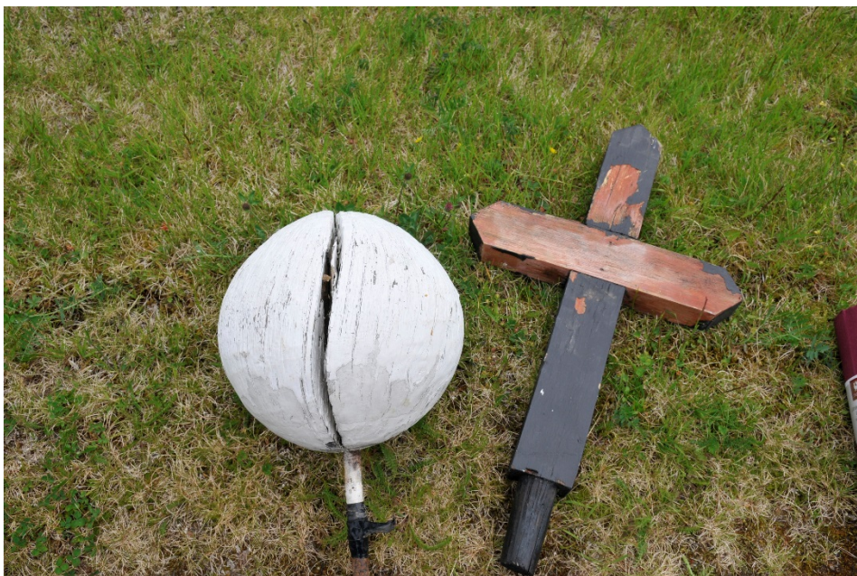
Figur 14 Korset var svartmålat med något som såg ut och flagade som plastfärg. Under detta fanns spår av förgyllning och ett rött färglager (grundning för förgyllning). Genom globen fanns en större torrspricka.
