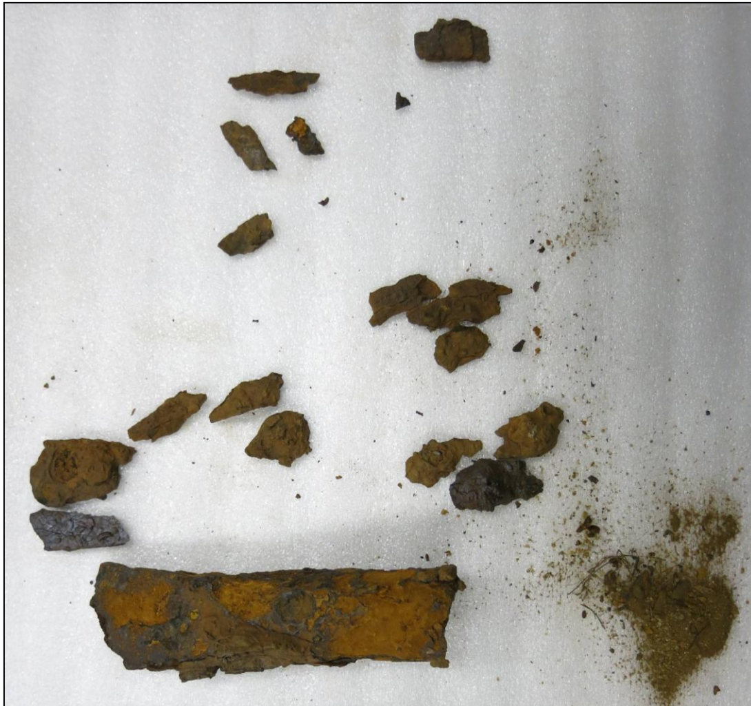
Som mottaget, med en stor mängd ytfragment som sprängts loss
