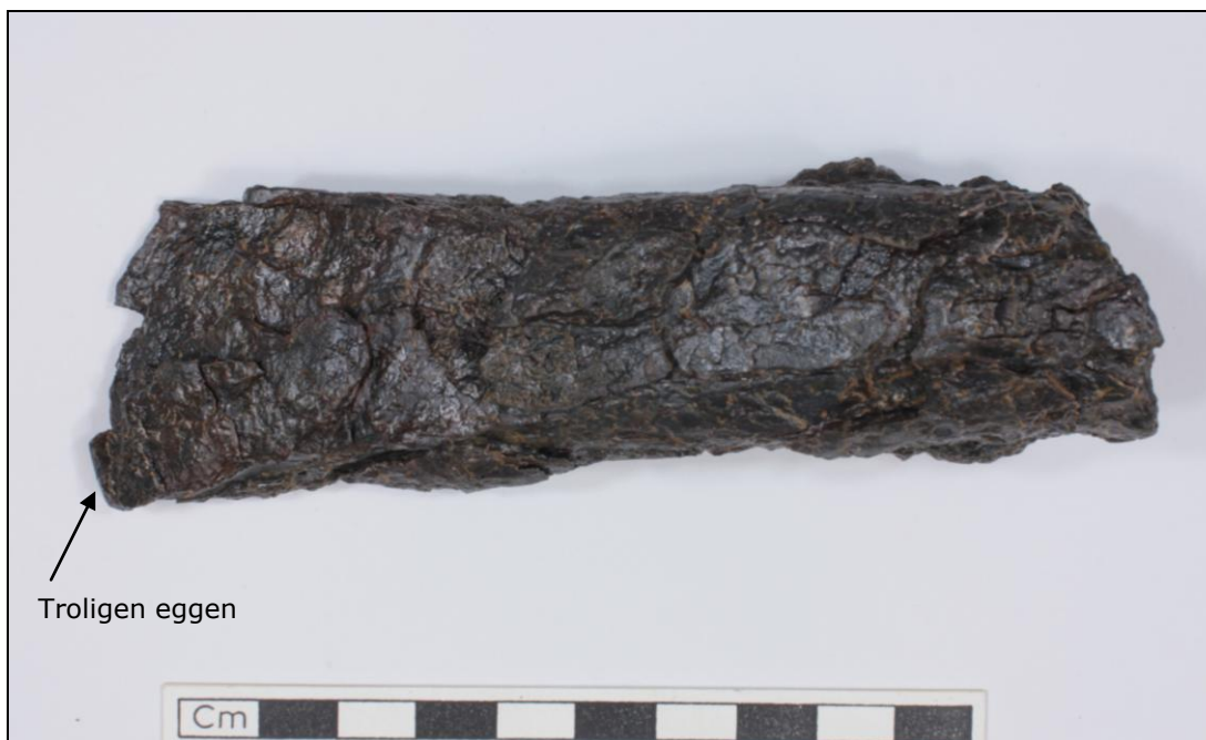
Efter urlakning, nedtrimning av korrosionsblåsor och ytbehandling (andra sidan)
